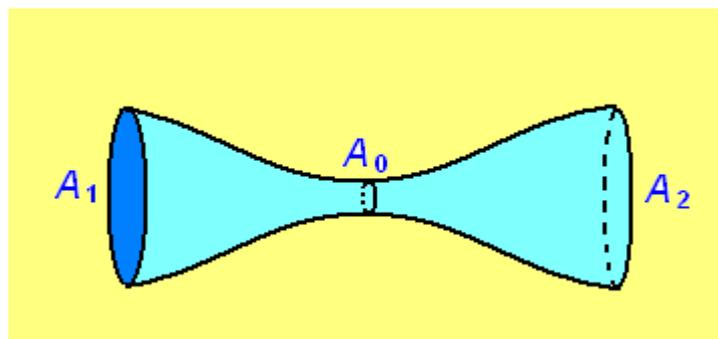
Das Gravitationspotential sei für die drei Querschnitte  $A_0$ ,  $A_1$  und  $A_2$  gleich oder (bei senkrechter Anordnung) annähernd gleich. Anwendung der BERNOULLI-Gleichung auf die Querschnitte  $A_0$  und  $A_2$  liefert:
