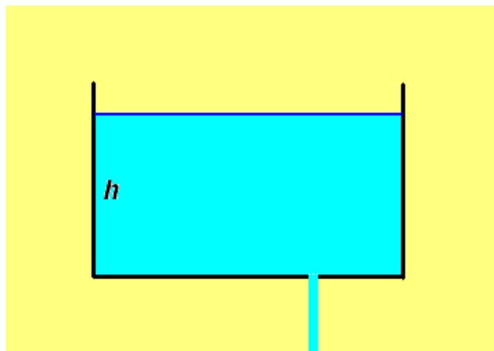
Da an der Oberfläche der Flüssigkeit überall derselbe Druck  $p_0$  (der Atmosphärendruck) herrscht, die Flüssigkeitsteilchen alle dieselbe Geschwindigkeit  $v$  (praktisch gleich 0) haben und sie außerdem in derselben Höhe  $h$  liegen, hat für alle Punkte der Oberfläche die Summe
