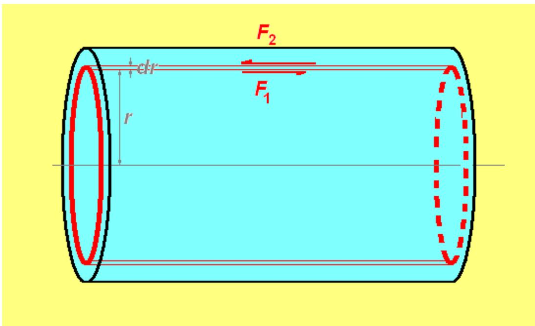
Als Volumenelement nehmen wir einen Hohlzylinder der Länge  $l$  mit den Radien  $r$  und  $r + dr$ . Da nach innen benachbarte Schicht hat eine größere Geschwindigkeit und übt daher eine Kraft in Richtung der  $+X$ -Achse aus:
