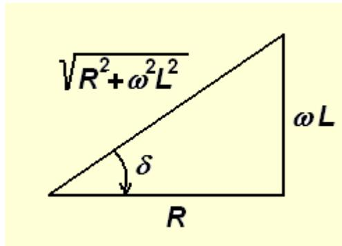
Zudem ist der Winkel unten links gleich dem Phasenverschiebungswinkel.
