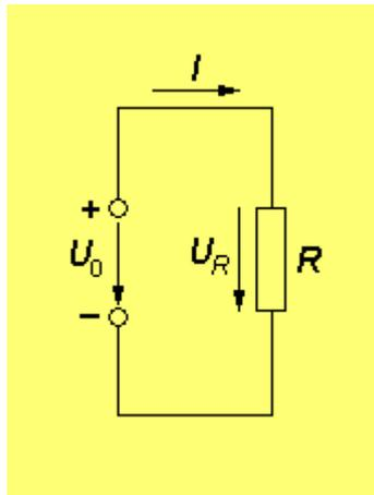
Links ist eine Gleichspannungsquelle mit der Quellenspannung  $U_0$ , rechts ein Schaltungselement (»Widerstand«), das nur einen Ohmschen Widerstand  $R$  hat. Der Ohmsche Widerstand der Leitungen und der »innere Widerstand« der Spannungsquelle seien vernachlässigbar klein. Gleiches soll für die Induktivität und die Kapazität der Leitungen gelten. (Sollte dies einmal nicht der Fall sein, müssen sie durch »Ersatzschaltglieder« berücksichtigt werden.)
