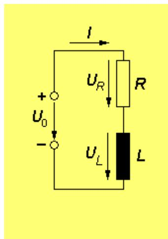
Wie wir oben (in Teil II) sahen, ist die Spannung an der Spule (die Potentialdifferenz zwischen ihrem oberen und ihrem unteren Ende) proportional zu  $dI/dt$ . Für  $dt > 0$  und  $dI > 0$  nimmt die Stromstärke mit der Zeit zu. Es ist daher konsequent, dem Zählpfeil von  $dI/dt$  dieselbe Richtung zuzusprechen wie
