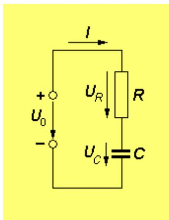
Auch hier haben die Zählpfeile für  $I$  und  $U_C$  dieselbe Richtung, da die obere Kondensatorplatte durch den Strom positiv, die untere negativ aufgeladen wird. Die obere Platte hat folglich das höhere Potential. Es gilt nun
