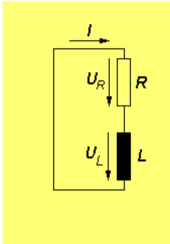
Wir betrachten nun den Ausschaltvorgang, bei dem die Spannungsquelle abgeschaltet und gleichzeitig das untere Ende der Spule mit dem oberen Ende des Widerstands verbunden werden soll. Die Zählpfeile lässt man dabei unverändert. Dann findet man bei einem geschlossenen Umlauf im Stromkreis
