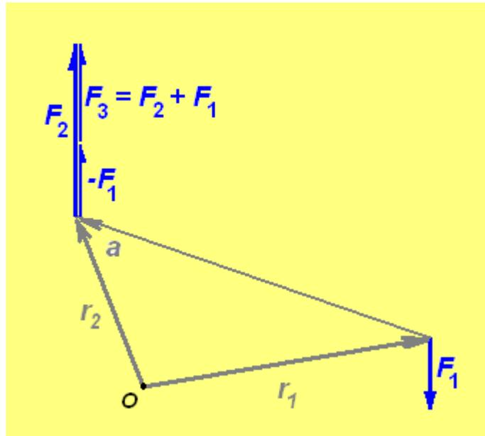
Ist  $F_2 = -F_1$ , so ist die Einzelkraft null. Dies ist ein einfaches Beispiel dafür, dass zwar  $F = 0$ , aber  $M'$  ungleich null sein kann.
