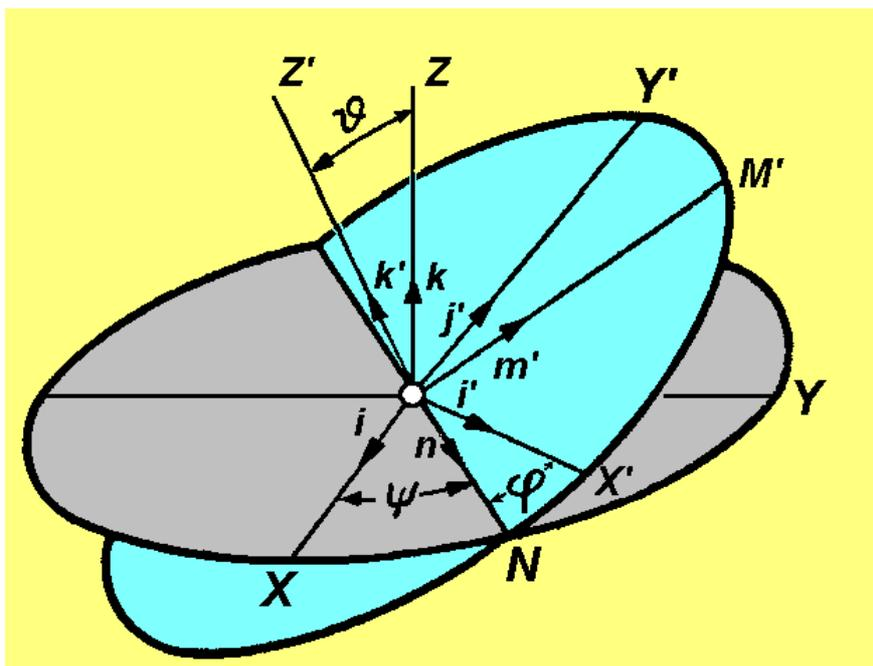
$\vartheta$  ist der Winkel zwischen der  $Z'$ -Achse und der  $Z$ -Achse. Die  $XY$ -Ebene (grau) schneidet die  $X'Y'$ -Ebene (grün) in einer Geraden, die Knotenlinie genannt wird und auf der der Einheitsvektor  $\mathbf{n}$  liegt. Senkrecht zu  $\mathbf{n}$  legen wir in der  $X'Y'$ -Ebene eine Gerade, auf welcher der Einheitsvektor  $\mathbf{m}'$  liegt.
