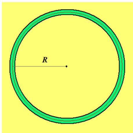
Die Spule sei eng gewickelt, habe  $n$  Windungen und werde vom Strom  $I$  durchflossen. Ihr Querschnitt sei  $A$ . Das Magnetfeld im Innern der Spule hat kreisförmige Feldlinien und ist nahezu homogen. Der Betrag der magnetischen Feldstärke in ihr ist analog zu der einer sehr langen Zylinderspule, wo sie
